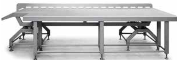
Распаковочный / дозировочный стол. Стол разделен на две части: одна часть для распаковки замороженных мясных блоков, а вторая - для взвешивания партий продукта.
