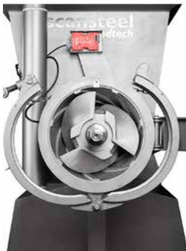
Передняя часть волчка SuperGrind 400/260 в разобранном виде с установленным шнеком. Система готова к установке режущего ножа с 3-мя лезвиями. Режущий нож вставляется в углубление шнека.
