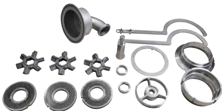
На картинке сверху показан тройной набор ножевого инструмента и съемные части эмульситатора scanEmul 175 в разобранном виде. Также показаны инструменты для сборки/разборки ножевого комплекта.
