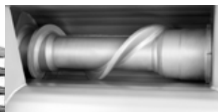
Шнек, установленный в корпусе волчка SuperGrind 400/260. Показан вид сверху.
