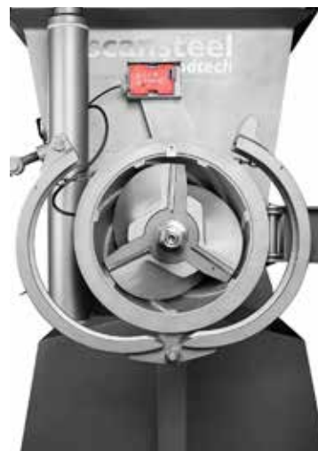
Передняя часть волчка SuperGrind 400/260 с установленным шнеком и с режущим ножом с 3-мя лезвиями в сборке.
