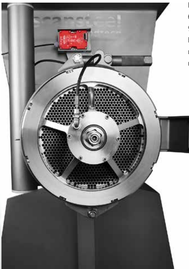
Передняя часть волчка SuperGrind 400/260 в разобранном виде с установленным шнеком. Система готова к установке режущего ножа с 3-мя лезвиями. Режущий нож вставляется в углубление шнека.
