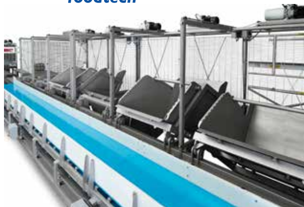
Станция взвешивания и дозирования, вид со стороны выгрузки продукта. Взвешивающая транспортерная лента расположена на тензодатчиках. Каплесборник предотвращает падение капель жидкости на пол.
