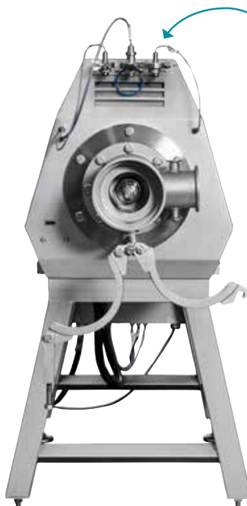
Эмульситатор scanEmul 175 показан в разобранном виде, готовый к чистке. Вид спереди.
