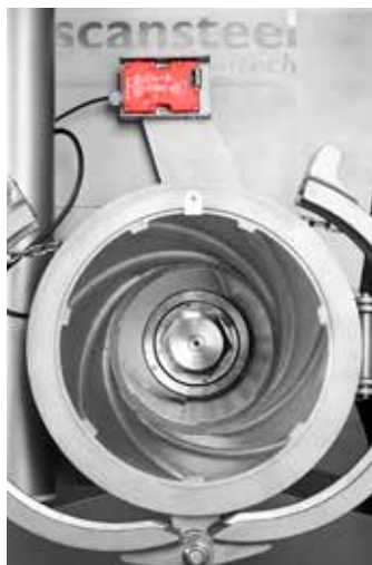
Устройство без шнека демонстрирует винтовые лопасти внутренней облицовки.
