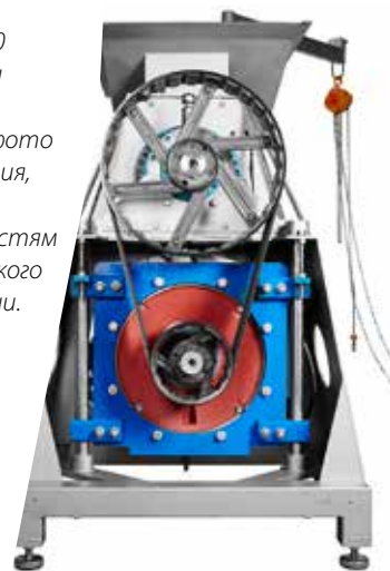
Волчок SuperGrind 400/260 - показан вид сбоку с демонтированными боковыми панелями. Разработан с учетом легкой доступности ко всем компонентам при техническом обслуживании и инспекции. Показана также автоматическая система смазки для основных и передних подшипников.
